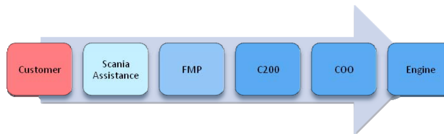
Figur 3. Illustration av systemen inblandade i en fjärravstängning.
